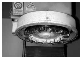
Fig. 10 Dettaglio testa strumentata con placchette diamantate in prova
