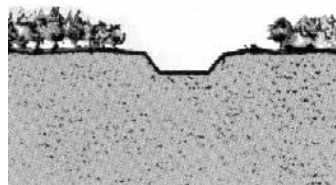
Fig. 1 Schema di giacimento di roccia calcarea, ad esempio di natura organogena o chimica, con debole copertura di terreno d’alterazione, presente con notevole spessore in un contesto morfologico di piano.
