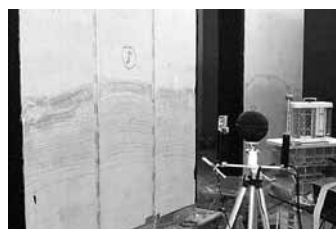
Figg. 12, 13 Prove di laboratorio presso l'IRIS-C.N.R. L'umidità nelle murature in tufo (monitoraggio ambientale)
