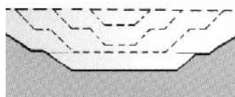
Fig. 2 Schema di coltivazione per splateamenti.
