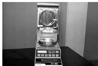
Figg. 14, 15: Prove di laboratorio presso l'IRIS-C.N.R. L'umidità nelle murature in tufo (strumenti di misura)
