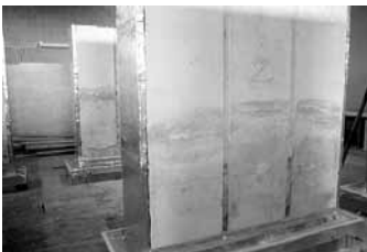
Fig. 20 Prove di laboratorio presso l'IRIS-C.N.R. L'umidità nelle murature in tufo (pareti campione in evidenza la risalita capillare)
