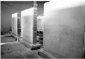
Fig. 16-17-18-19 Prove di laboratorio presso l'IRIS-C.N.R. L'umidità nelle murature in tufo (pareti campione)
