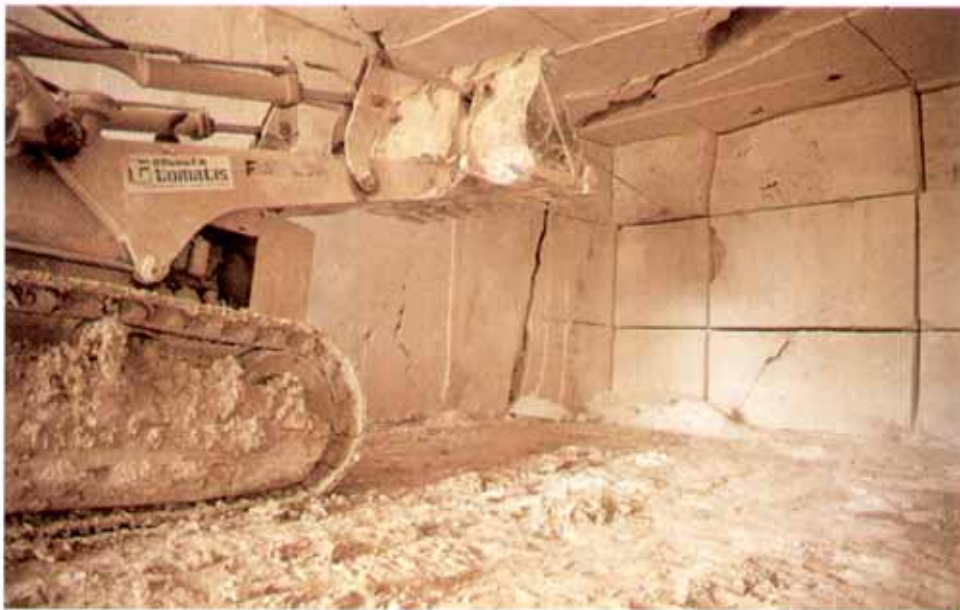
Tavola XXVII – Fase iniziale di una coltivazione in sotterraneo: dopo esserne stata forzata la parte posteriore con gli impianti idraulici, il blocco, imbragato, viene estratto per mezzo della pala meccanica cingolata. Si osservi anche la grossa frattura che attraversa obliquamente la roccia a tetto.
