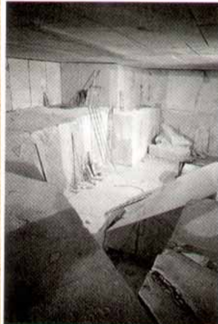
Fig. 59 – Cava di marmo bianco in sotterraneo (Carrara). Le cave in sotterraneo raggiungono spesso un notevole sviluppo con ampi spazi di manovra che consentono di effettuare le operazioni di escavazione come nelle cave a cielo aperto.
